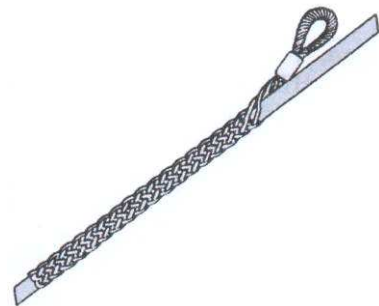
Chaussette de tirage du câble.
