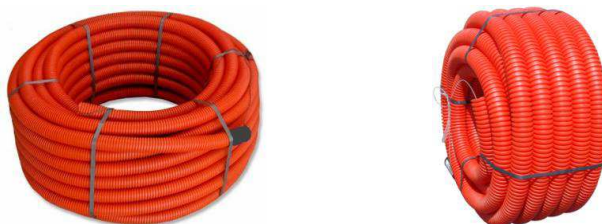
Gaine TPC avec et sans manchon, cintrable de couleur rouge équipé d'un tire-fil (résistance de 40 à 60 daN) – existe en longueur de 25 ou 50 mètres.
