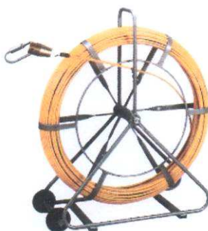
Aiguille de tirage du câble.
