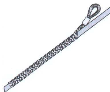
Chaussette de tirage du câble.
